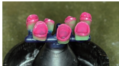
● スプルーを立て、鑄造するための埋没作業を行います
