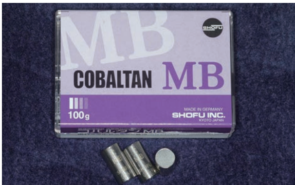
● コバルトクロム合金の加工前の状態です。これを鑄造という技法で、内冠、外冠に成形していきます
